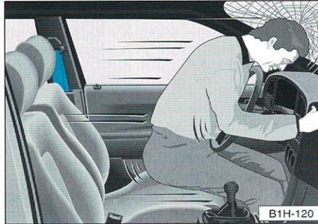
Bei einem Frontalunfall werden nicht angegurte Insassen nach vorne geschleudert und schlagen unkontrolliert auf Teile im Fahrzeuginnenraum, wie z.B. Lenkrad, Instrumententafel, Windschutzscheibe auf.
